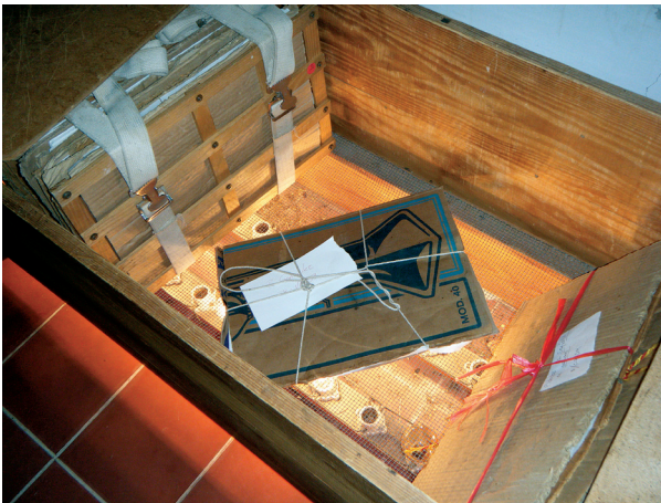
Lámina 29. Se observa la secadora que se utiliza en la deshidratación de las muestras de plantas, las que se colocan en la reja situada encima de las lámparas incandescentes. Fotografía de L. Hernández H.
